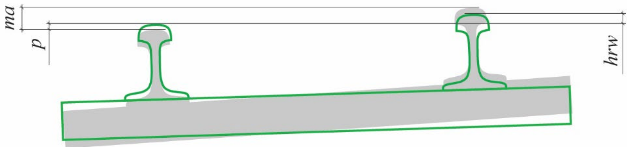
Рис. 4.16. Перша гранична умова (на цьому і подальших рисунках сірим сполосним кольором показано існуюче положення рейко-шпальної решітки, зеленим контуром – розрахункове)
