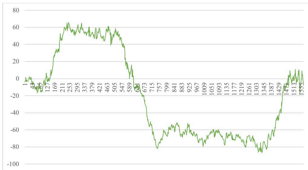
Рис. 3.10. Підвищення по ходу руху лівої рейки над правою для робочого маятника
