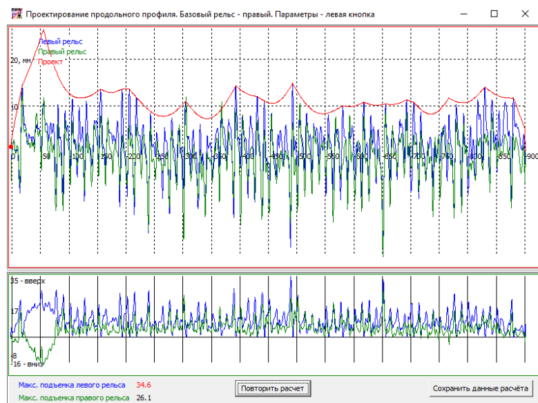
Рис. 5.26. Розрахунок виправки колії в поздовжньому профілі, експеримент на перегоні Ожидів-Заболотці
