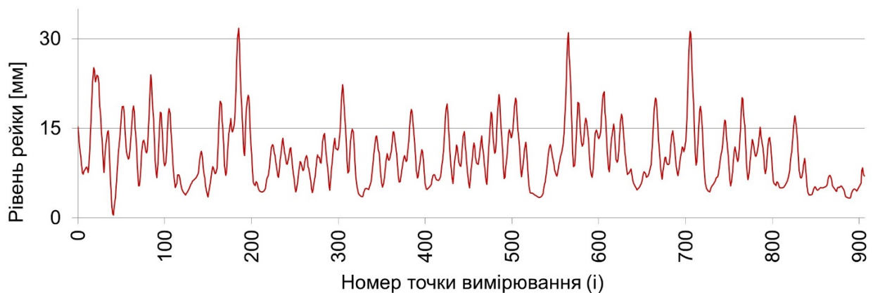
Рис. 5.14. Результати розрахунку виправки колії комп'ютерною програмою RWPlan Strela для лівої рейки на обраній ділянці
