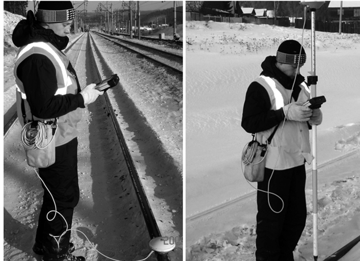
Рис. 2.11. «Мануальна» зйомка колії за допомогою GPS датчика
