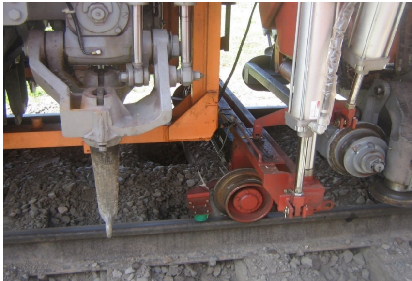
Рис. 5.4. Робочий візок контрольно-вимірювальної системи машини ВПР
