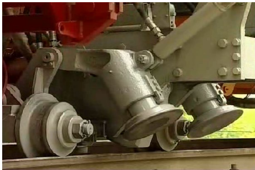
Рис. 5.8. Підйомно-рихтувальний пристрій (ПРП) системи виправки машини ВПР
