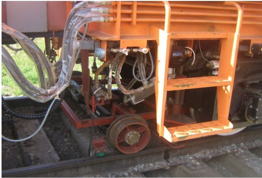
Рис. 5.5. Контрольний візок контрольно-вимірювальної системи машини ВПР
