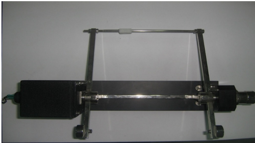
Рис. 5.6. Потенціометричний датчик нівеліровочної системи
