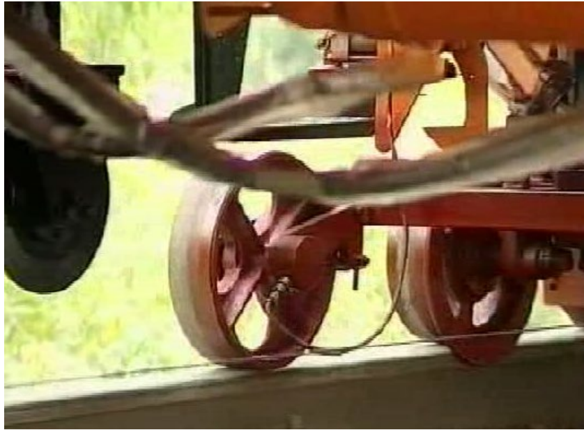
Рис. 5.7. Вимірювальне колесо контрольно-вимірювальної системи машини ВПР
